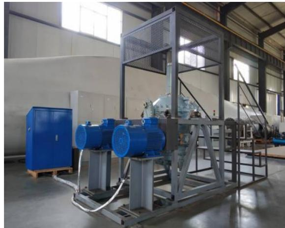
基于原型机的直升机主减速器实验平台
