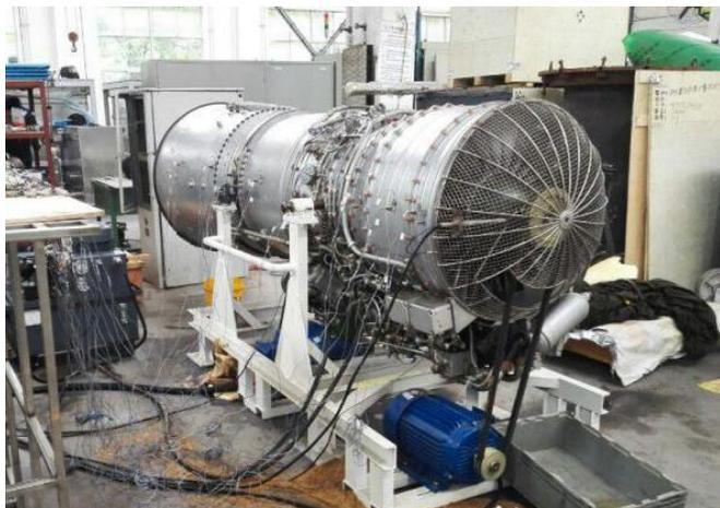
基于原型机的航空发动机实验平台
